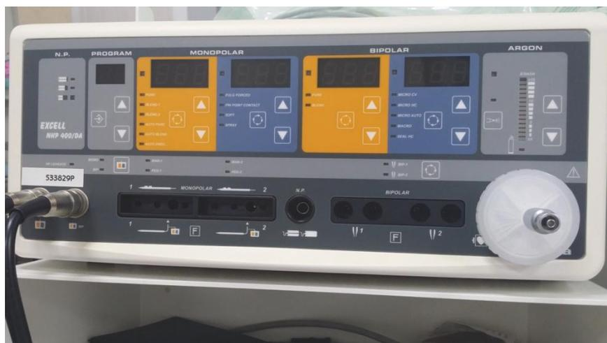
**Рис. 2.6. Аппарат аргоноплазменной коагуляции**
